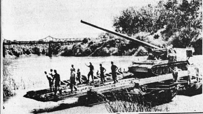
Esta es una de las piezas más modernas con la que cuenta la artillería norteamericana en Viet Nam. Se trata de un cañón de 31 toneladas para piezas de 175 milímetros. Este cuenta con su propio motor para su desplazamiento. (AP Wirephoto)
