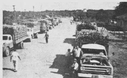
El abastecimiento de caña al Ingenio se efectúa por medio de co- miones, que en la presente zafra alcanzan aproximadamente a 300 vehículos por día, y que depositan un tonelaje de 2,300 toneladas para alimentar la molienda cada 24 horas.
