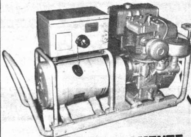
**CON MOTOR A GASOLINA BRIGGS & STRATTON DE 15-3 Y 5 KVA 220 V. 50 c/s.**
