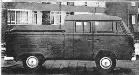
**CABINA DOBLE VW. Con una superficie de carga de 2,9 m<sup>2</sup>, una capacidad de transporte de 950 kg y asientos para 6 personas. Frenos de discos - mayor comodidad, el vehículo de doble función.**
