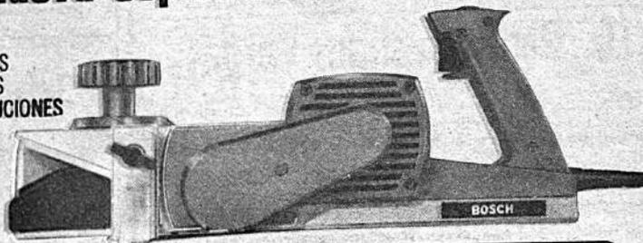
La cepilladora de mano Bosch I590 permite efectuar los cambios de profundidad de corte incluso durante la marcha en escalones exactos de 0,25 mm cada uno. Al hacer rebajes, la graduación de corte se efectúa sin escalonamiento.
