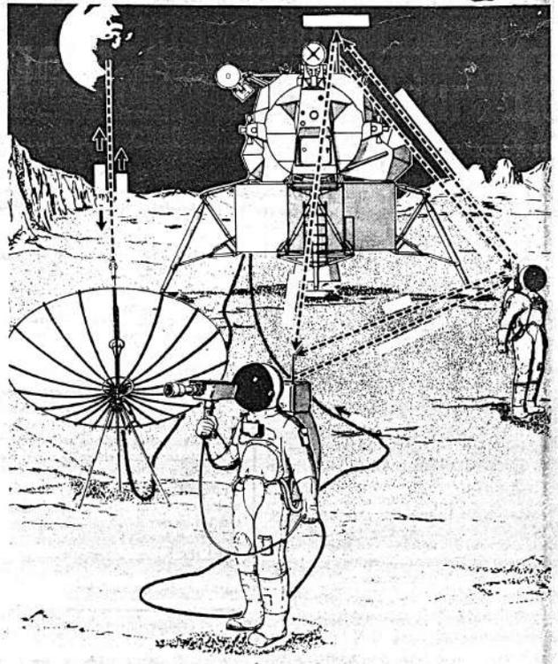
COMUNICACION LUNAR.— El dibujo muestra el sistema de comunicación hablada por TV y para la transmisión de Apolo 13, durante su actividad extravehicular en la superficie de la Luna. Las señales son transmitidas por una antena del Módulo Lunar, emplazadas después del descenso, al Centro de Vuelos Espaciales Tripulados en la Tierra (foto superior izquierda). (Foto USIS).—
