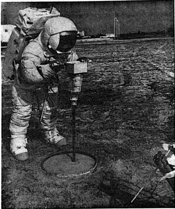
El astronauta Fred Haise, piloto del Módulo Lunar Apolo 13, realiza una práctica con una perforadora que permite, por medio del calor, medir la temperatura de la Luna a una profundidad de tres metros, así como determinar el valor de la conductividad termal de la Luna a la misma profundidad. Este ensayo se realiza dentro del programa previo al viaje de Apolo 13 el 11 de abril.
