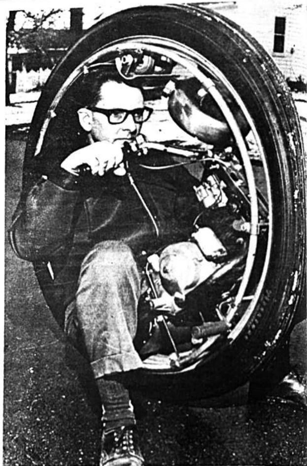
El inventor Lafrance Bressen, vio un viejo modelo de 1920 de un motorciclo de una sola rueda y construyó el suyo. En la fotografía aparece utilizando su invento, dentro de una rueda de 36 pulgadas impulsada por un motor de 50 cc.— (AP Wirephoto).
