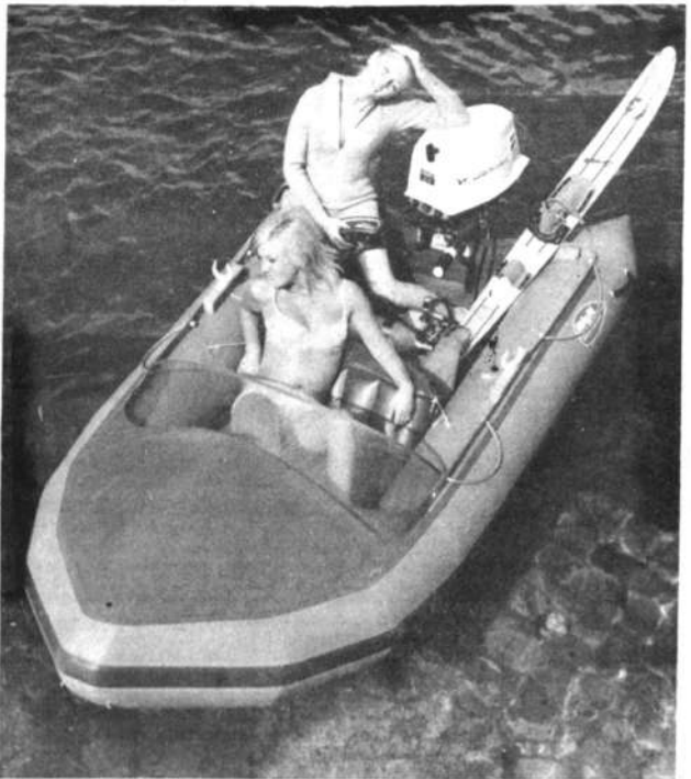
NUEVOS BOTES.— Una compañía británica acaba de producir el "S400 Sportboat", un modelo de la nueva serie de botes inflables para dar un buen rendimiento con carga completa. Puede llevar un motor de 40 H.P. y remolcar dos esquíadores en línea recta o haciendo virajes. Pesa 62 kgs. y puede armarse en 15 minutos.
