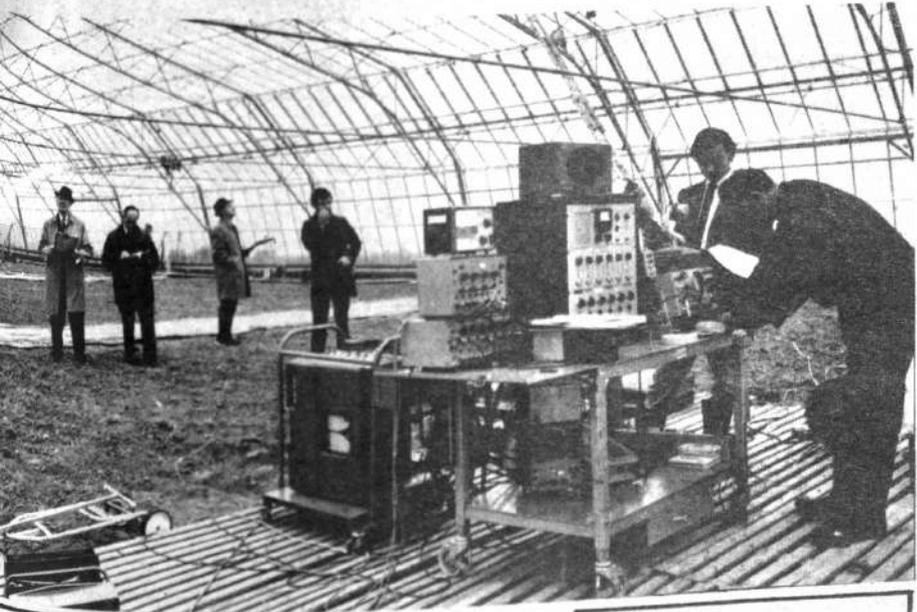
**SIMULACRO.**— Para determinar los efectos que tendrá el estampido del "Concorde" inglés-francés en las estructuras de vidrio, especialistas de la Universidad de Southampton hicieron experimentos simulando el estampido sónico para registrar sus ondas de choque y posibles efectos sobre dichas estructuras.
