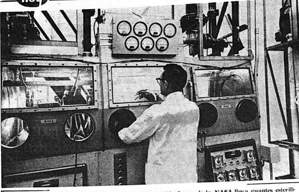
Contaminación.— Un técnico del Laboratorio de Recepción Lunar de la NASA lleva guantes esterilizados para alimentar a una rata que está dentro de una cámara sellada. La rata, libre de gérmenes, será expuesta a los materiales lunares que traigan los astronautas de la Misión Apolo 11, para pruebas de contaminación lunar.
