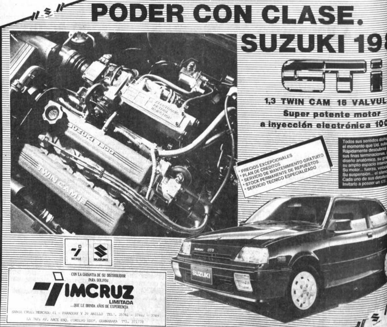
1.3 TWIN CAM 16 VALVULA Super potente motor a inyección electrónica 100%
