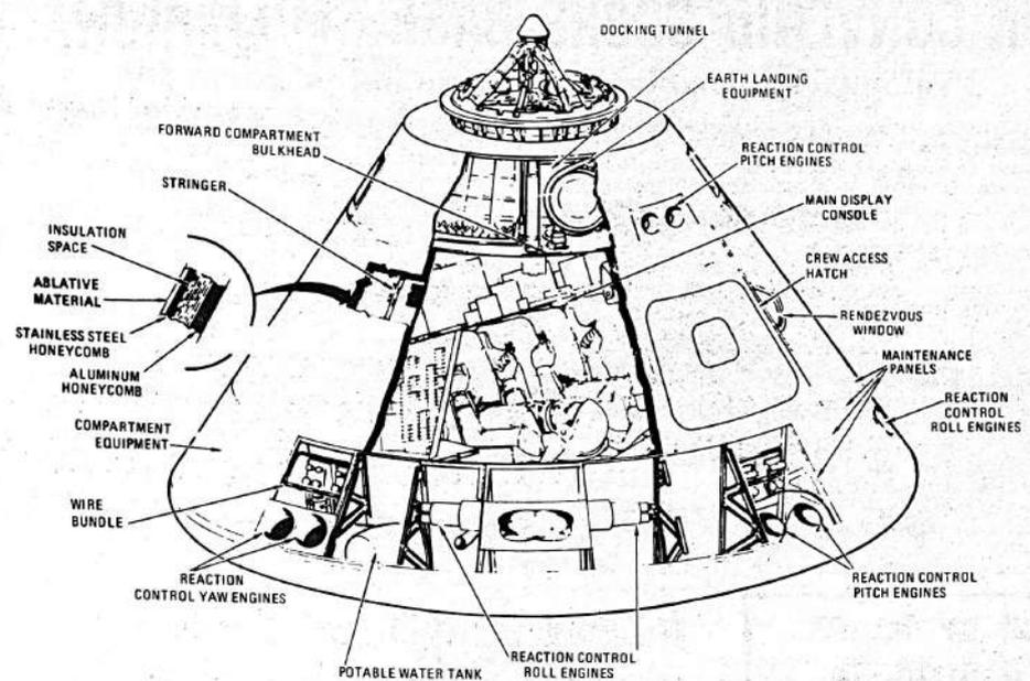
Corte transversal, en dibujo, de la cabina del Módulo de Comando de la nave Apolo 11, que fraerá de vuelta a la Tierra a los astronautas Armstrong, Collins y Aldrin, después de su viaje hasta la superficie lunar. El lanzamiento ha sido confirmado para el 16 de julio próximo y se espera que nada pueda interrumpir este plan haciendo que el vuelo se retrase por algún tiempo.
