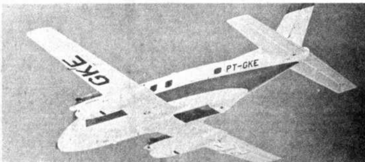
EMB-110 B1 Avión aerofotogramétrico. Especial y construido para trabajos de aerofotogrametría. Puede ser transformado en avión de transporte de pasajeros.
