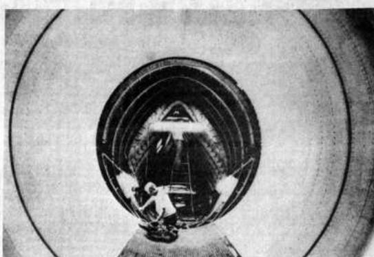
AIRE PARA EL MOTOR: Se trata del ducto de toma de aire de uno de los aviones comerciales TriStar L-101 de la Lockheed-California Company. El enorme tubo en forma de tunel se encuentra montado en la parte superior del avión, en frente del timón vertical y proporciona el aire necesario para el motor No. 2, ubicado en la cola (CFS).
