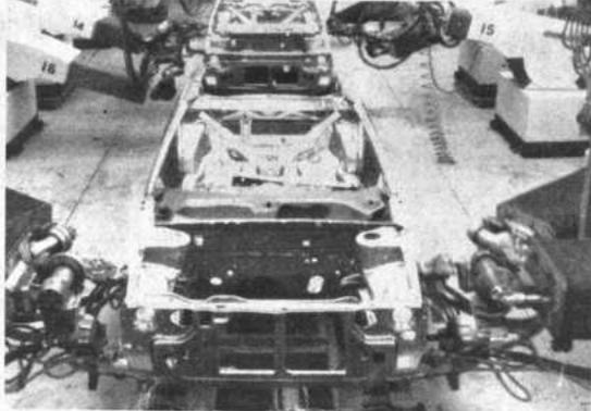
LINEA DE MONTAJE AUTOMATIZADA: Soldadores robot buscan y sueldos críticos en carrocerías de autos en esta línea de montaje de la planta de San Luis, Misouri, de la Corporación Chrysler. (USIS).
