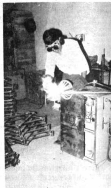
Soldadura múltiple, preparación de marcos.
